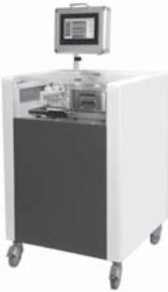
図8 旭川医大中央精工(株)にて製作された肝臓灌流保存装置。
